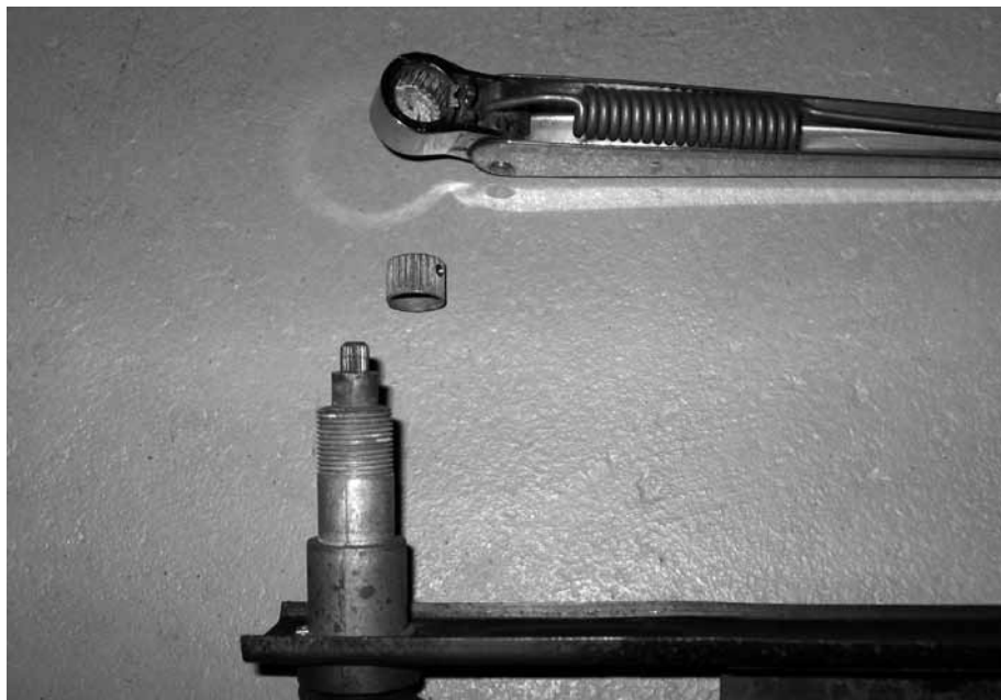
Lösningen blev ett gänghål i sidan på axelstumpen.
