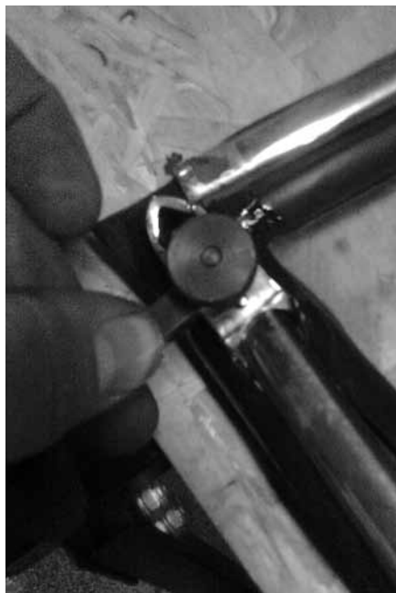
Ett specialverktyg som underlättar kromlistmontering.
