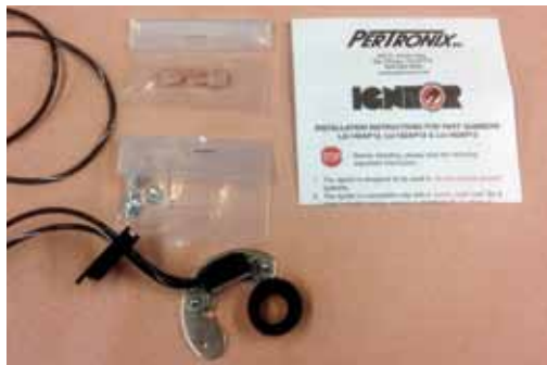
Komponenterna som ingår: Platta och elektronikdel, triggerhjul, skruvar och muttrar för montering, kabelskor, buntband och ett bladmått av platt.
