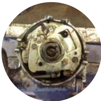
Brytarspets och kondensator demonterade.
