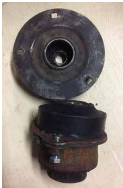
Bild 1. Gör en mall och borra nya hål. Svetsa sedan fast nya muttrar i Volvos lagring.
