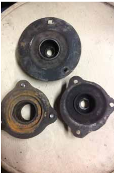
Bild 2. Överst Volvo original lagring, tv Cortina original och th en modifierad Volvo lagring.
