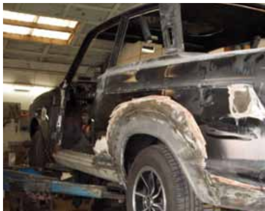
Omfattande rostreparationer med karosseridelar från
