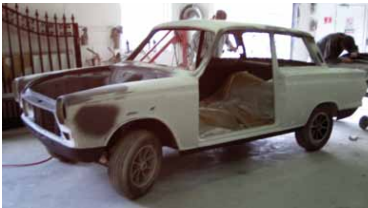
Underarbete inför lackning utfört av pensionerad målarmästare.
