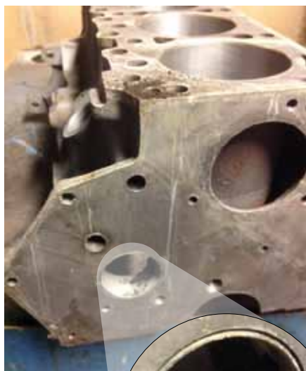
Den här stenhårda klumpen satt i oljekanalerna och hindrade oljan att nå vipparmsbryggan.
